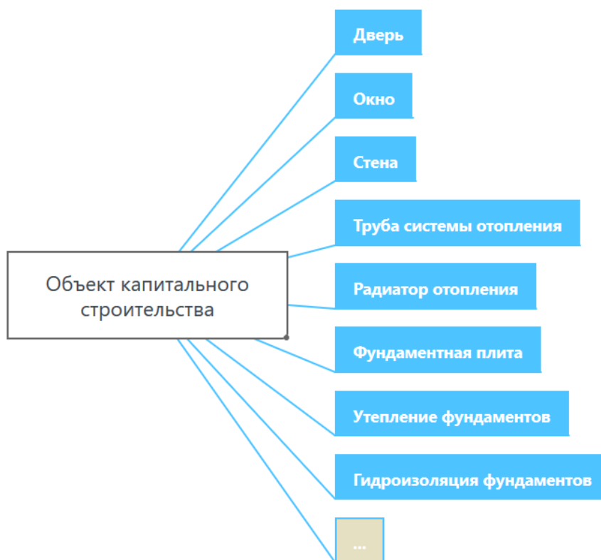
Рисунок 4.3.2.1 – Объекты, входящие в состав объекта капитального строительства
